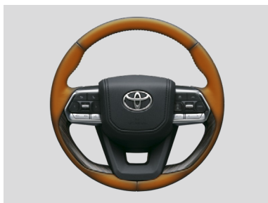
■ ヒーター加温箇所
